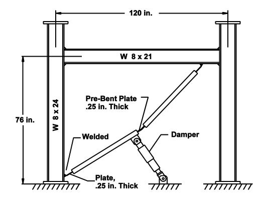
FIGURE 5 TESTED FRAME WITH TOGGLE BRACE-DAMPER SYSTEM
